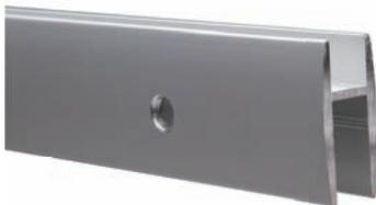
El Perfil para el flujo de aire RoscoVIEW es un perfil de aluminio modificado que se coloca en la parte de abajo del panel RoscoVIEW cuando se instala en la ventana. Permite el flujo necesario de aire detrás del panel para reducir la acumulación de calor o condensación.
